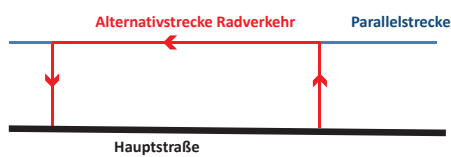
Abb. 53: Bei dieser Art der Umfahrung eines Abschnittes der Hauptstraße ist der Umweg für den Radfahrer deutlich wahrnehmbar, die Akzeptanz ist gering.
