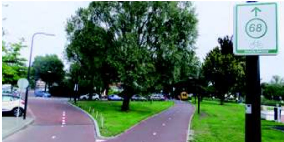
Eine Desire Line der besonderen Art: In Rjswijk (Niederlande) können Radfahrer, die nach rechts weiterfahren wollen, eine Abkürzung nehmen. Wer links weiterfährt, erreicht nach etwa 150m (dort, wo das blaue Fahrzeug zu erkennen ist) einen kleinen Kreisverkehr, von wo aus ebenfalls die Möglichkeit besteht, die Fahrt nach rechts fortzusetzen. Das Schild rechts im Bild zeigt an, dass der Weg zum Knotenpunkt Nr. 68 führt.
